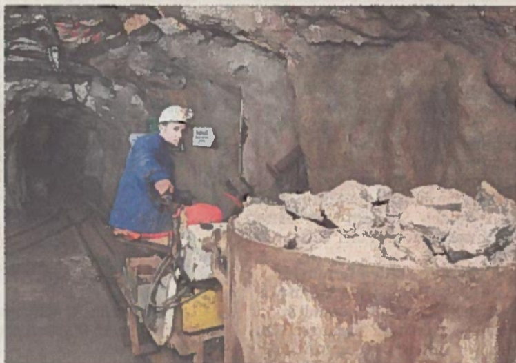
David Helm fährt den Kübel mit rund 300 Kilo Erz zum Albertschacht. Dort wird mit einer Winde das Material an die Luft gezogen.
