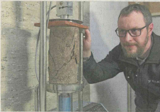
Geotechniker Andreas Köhler schaut sich an der Druckpresse das Bohrkernmaterial aus einer Tiefe von knapp 54 Metern an. Die Daten fließen in die Entscheidung über die Wahl des Sicherungsbauwerkes im Augustusschacht auf der Anlage des Freitaler Kleingartenvereins Rotkopf Görg ein. Mehr als eineinhalb Jahre ist es jetzt hier, dass in der Freitaler Kleingartenanlage des Vereins Rotkopf Görg bei einem Tagebruch die Erd- und Gesteinsschichten über dem Augustusschacht in die Tiefe rutschten. Bis die genaue Schachtverwahrung feststeht, ruht die Baustelle weiter.
